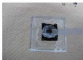
⑤穴開き板に黒鉛シート，金網-極，鱗，カーボン，金網+極を付ける
